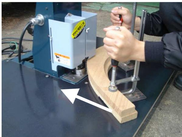
型をガイドに当てながら材料を移動して加工すると、型と同じ形状に加工したい材料が加工出来ます。
