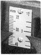
高さの目盛りを1-①の項で決定した加工材の高さ(1寸)に合わせる。
